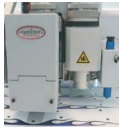
OptiSCOUT Kamera mit Gehäuse montiert auf Mehrfachwerkzeugkopf
