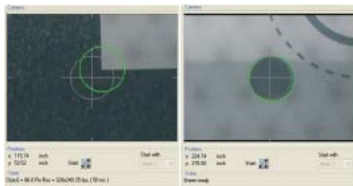
Abb. Links: Fadenkreuz Kamera und erkannte Blattecke (grün)
